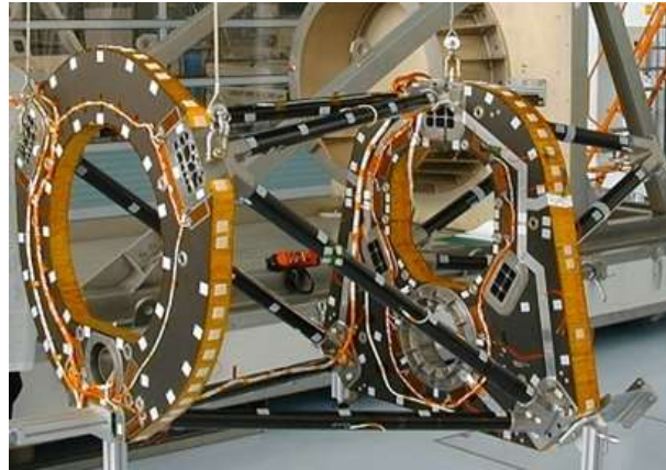
Cryostat d'Herschel : He à 1,7K
