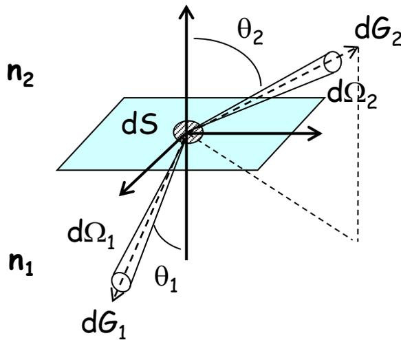
On considère une interface entre deux milieux d'indice  $n_1$  et  $n_2$  et un faisceau incident avec un angle  $\theta_1$ . La loi de Descartes s'écrit:
